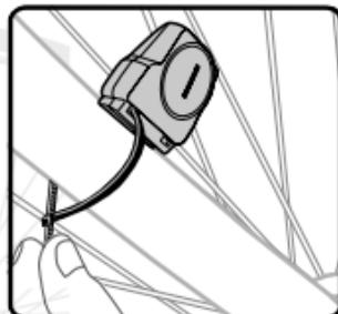
On peut ajuster le placement le long de la branche de fourche, selon le besoin. *Fixer le capteur avec une attache zip. Ne pas serrer à fond, car il y aura peut-être besoin de réglages supplémentaires.*
