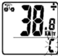
**TEMPERATURA (TEMP)** – Su ciclocomputador incluye un termómetro para medir la temperatura ambiental. Para seleccionar la lectura ya sea en Celsius (C) o Fahrenheit (F), pulse y mantenga pulsado el botón de IZQUIERDO durante dos segundos. Pulse el botón de DERECHO para seleccionar entre grados C y F y pulse el botón de IZQUIERDO para confirmar. Ahora pulse el botón de DERECHO para avanzar a la modalidad de Gasto de calorías (CAL).
