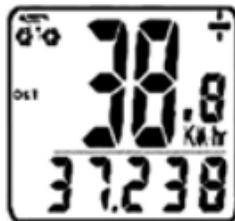
**VELOCIDAD MÁXIMA (MXS)** – MXS indica la velocidad máxima y aparece en la línea más inferior. La velocidad máxima se almacena en la memoria y se actualiza únicamente si se logra una velocidad más alta. Para restaurar MXS, pulse y mantenga pulsado el botón de IZQUIERDO durante dos segundos. Ahora pulse el botón de DERECHO para avanzar a la modalidad de Velocidad promedio (AVS).
