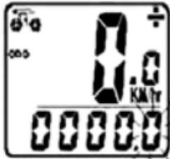
**VITESSE MOYENNE (AVS)** – La vitesse moyenne est indiquée par le sigle AVS et est affichée sur la ligne du bas. La vitesse moyenne fonctionne de pair avec le Chronométrage (TM) pour le calcul de la vitesse moyenne d'une course particulière. Appuyer sur le bouton de DROITE pour passer au mode Chronométrage (TM).
