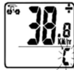
**TEMPÉRATURE (TEMP)** – L'ordinateur comporte un thermomètre mesurant la température extérieure. Pour choisir entre les unités degré Celsius (°C) ou Fahrenheit (°F), appuyer sur le bouton de GAUCHE et le maintenir enfoncé pendant deux secondes. Appuyer sur le bouton de DROITE pour choisir entre C et F et appuyer sur le bouton de GAUCHE pour confirmer. Appuyer ensuite sur le bouton de DROITE pour passer au mode Calories brûlées (CAL).
