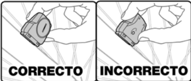
Coloque el sensor del ciclocomputador en lado derecho de la horquilla delantera de manera tal que: **A)** El compartimiento de la pila está dirigido hacia fuera de la bicicleta. **B)** El sensor está tal cerca de los rayos como sea posible. Usted puede ajustar la posición según corresponda.
