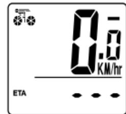
**ETA** – Cette fonction estime la durée nécessaire pour effectuer un parcours (estimation de l'heure d'arrivée). Pour configurer l'ETA, entrer dans le mode ETA, maintenir le bouton GAUCHE enfoncé pendant 2 secondes. Si la distance à parcourir est 0, des tirets --- s'affichent ; si la distance à parcourir a une valeur donnée, cette valeur s'affiche sur l'écran et le premier chiffre à droite clignote ; appuyer sur le bouton
