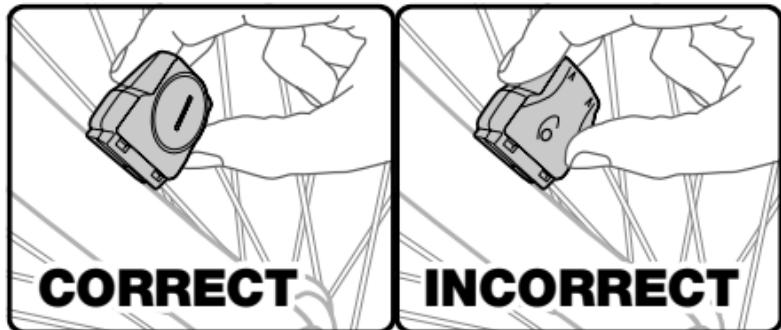
Placer le capteur sur la branche de droite de la fourche en s'assurant que : **A)** Le compartiment de la pile fait face à l'extérieur. **B)** Le capteur est aussi proche que possible des rayons.
