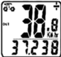
**VITESSE MAXIMUM (MXS)** – La vitesse maximum est indiquée par le sigle MXS et est affichée sur la ligne du bas. La vitesse maximum est enregistrée dans la mémoire et ne s'actualise que si l'on atteint une vitesse supérieure. Pour remettre la valeur MXS à zéro, appuyer sur le bouton de GAUCHE et le maintenir enfoncé pendant deux secondes. Appuyer ensuite sur le bouton de DROITE pour passer au mode Vitesse moyenne (AVS).
