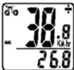
**RÉTROÉCLAIRAGE EL** – Illumine l'écran de l'ordinateur et facilite la visualisation de nuit ou par éclairage faible. Pour l'activer, tapoter le bouton central au sommet du boîtier.
