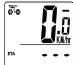
**ETA** – Esta función estima el tiempo requerido para recorrer la distancia. Para configurar ETA, entre al modo ETA, mantenga pulsado el botón IZQUIERDO durante dos (2) segundos. Si la distancia de recorrido es 0, se visualizará ---; si la distancia de recorrido tiene algún valor, los datos de distancia de recorrido se visualizarán en la pantalla y el primer dígito a la derecha se iluminará intermitentemente; pulse el
