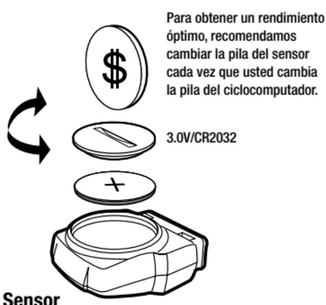
Para obtener un rendimiento óptimo, recomendamos cambiar la pila del sensor cada vez que usted cambia la pila del ciclocomputador.
