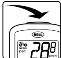
**INICIO/PARO AUTOMÁTICO** – Para conservar las pilas, el ciclocomputador se apagará automáticamente si se deja sin usar durante más de cinco a seis minutos. La visualización volverá a aparecer si recibe entradas del sensor o si el usuario pulsa algún botón.
