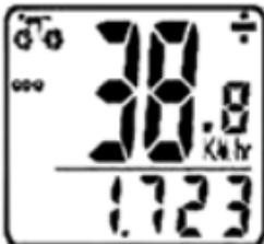
**COMPARATEUR DE VITESSES** – Un signe « + » ou « - » apparaît à droite de la vitesse. « + » indique que l'on roule plus vite que la vitesse moyenne (AVS). « - » indique que l'on roule moins vite que la vitesse moyenne.
