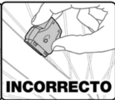
Coloque el sensor del ciclocomputador en lado derecho de la horquilla delantera de manera tal que: **A)** El compartimento de la pila está dirigido hacia fuera de la bicicleta. **B)** El sensor está tal cerca de los rayos como sea posible. Usted puede ajustar la posición según
